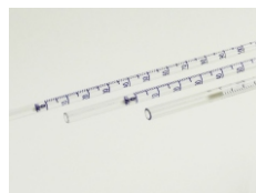
采用H 2 OStop® 遇水封闭滤芯的血沉检测管
